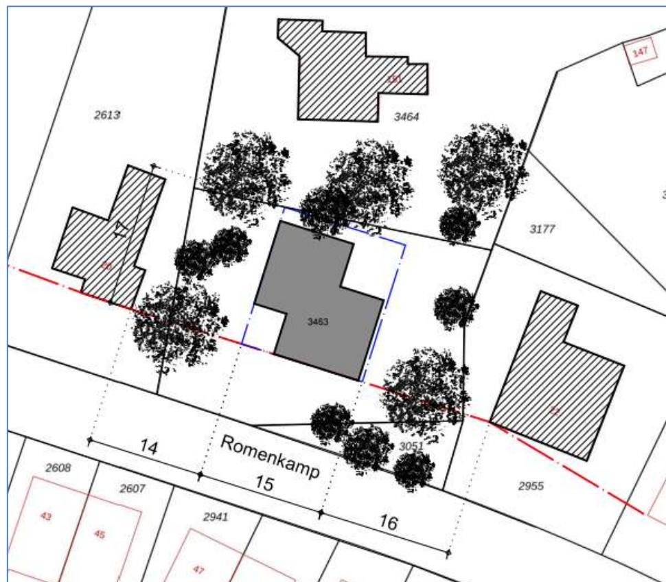
Figuur 4. Plattegrondsituatie schetsontwerp, bouwvlak is 15 x 17 meter.
